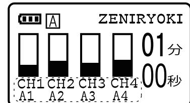
※電池動作では、すべての加温モードがCH1(出力1)で決定されます。そのため、上記のように設定した場合、右図のように反映されます。
